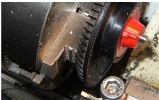
Abb. 1: Nicht jedermanns Sache: ein fischertechnik-Reifen in der Drehbank. Die Nabenflügel waren auch im Weg.
