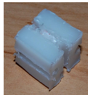
Abb. 8: Ergebnis C: Baustein 15 mit Nuten an allen sechs Seiten
