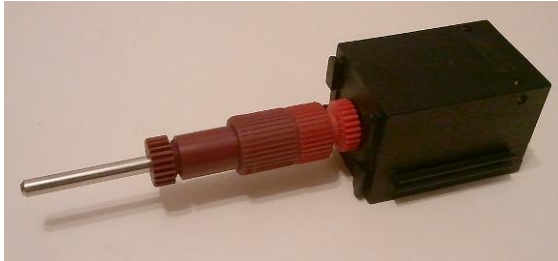
Abb. 28: Direktantrieb von einer Motorschnecke aus
