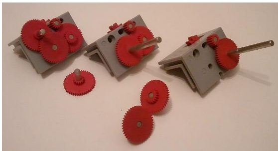
Abb. 4: Variable Untersetzungsverhältnisse beim Stufengetriebe
