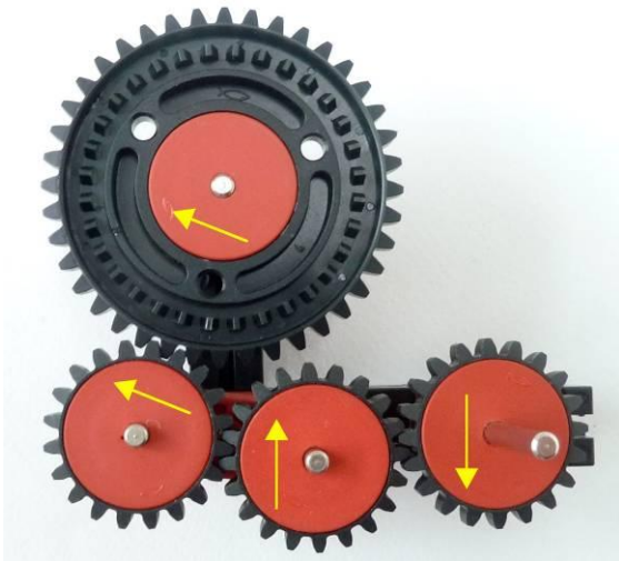
Abb. 3: Eingangswelle gegen den Uhrzeigersinn – Ausgangswelle im Uhrzeigersinn
