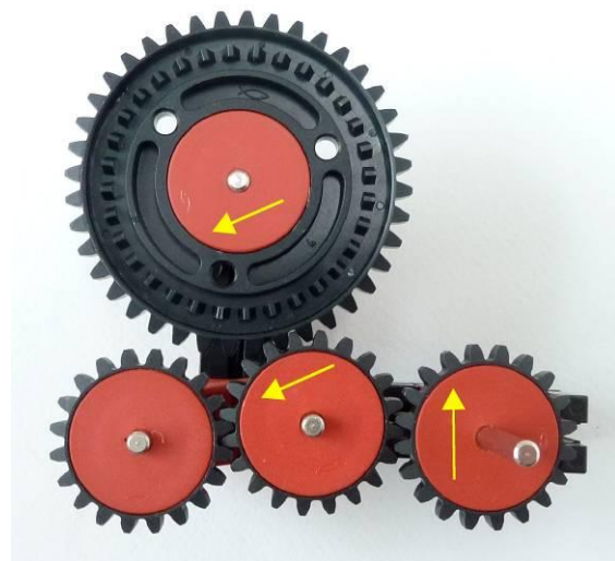
Abb. 2: Eingangswelle im Uhrzeigersinn - Ausgangswelle im Uhrzeigersinn
