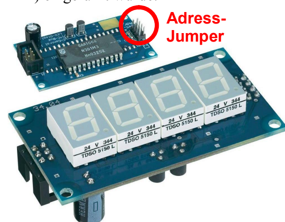
Abb. 1: LED-Display SAA1064 mit Adress-Jumper (Bild: www.conrad.de )
