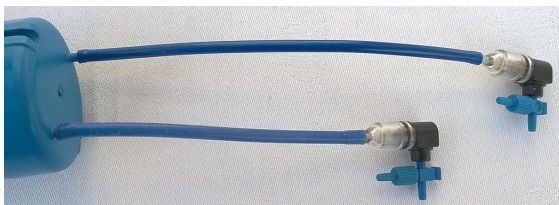
Abb. 9: Schutz gegen stoßweise ankommende Druckluft
