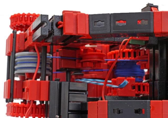
Abb. 26: Seilführung mit Messung der Seilkraft
