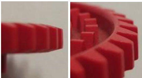
Abb. 9: Z40 mit Evolventen und Anspitzung
