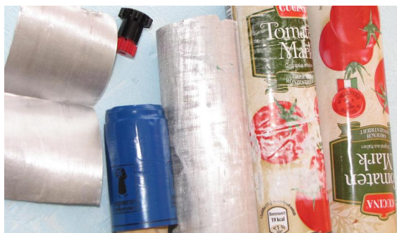
Abb. 3: Alu-Bleche von Tuben und Weinflaschen. Links außen wurde ein Tubenfalz unbeachtet gelassen, da hat man nicht lange Freude dran.
