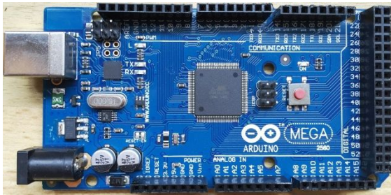
Abb. 2: Arduino-MEGA 2560R3. PORT K liegt unten rechts, bezeichnet als A8-A15.
