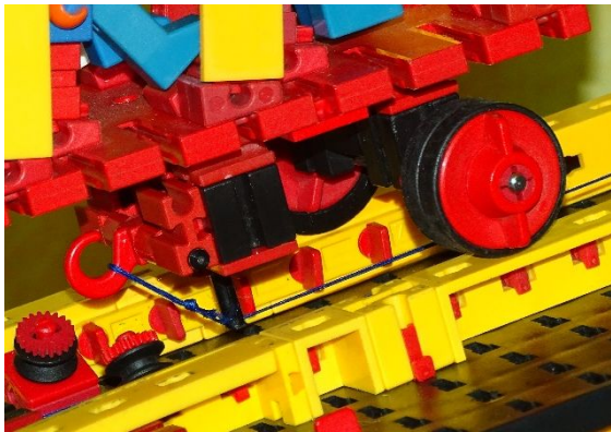
Abb. 3: Seilaufhängung unterhalb des Schienenniveaus
