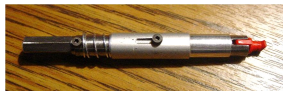
Abb. 4: Bit-Einsatz mit zurück gezogener Zentrierhülse
