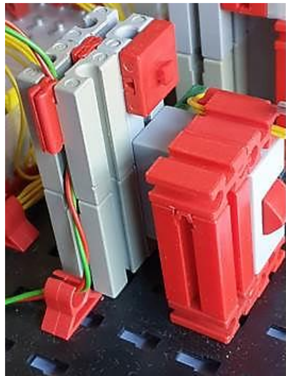
Abb. 4: Sockel für die Zählermodule
