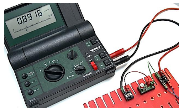
Abb. 9: Betrieb der Basis-Kollektordiode in Durchlassrichtung: BC 140 Kleinleistungstransistor mit Basisvorwiderstand 10\text{ k}\Omega
