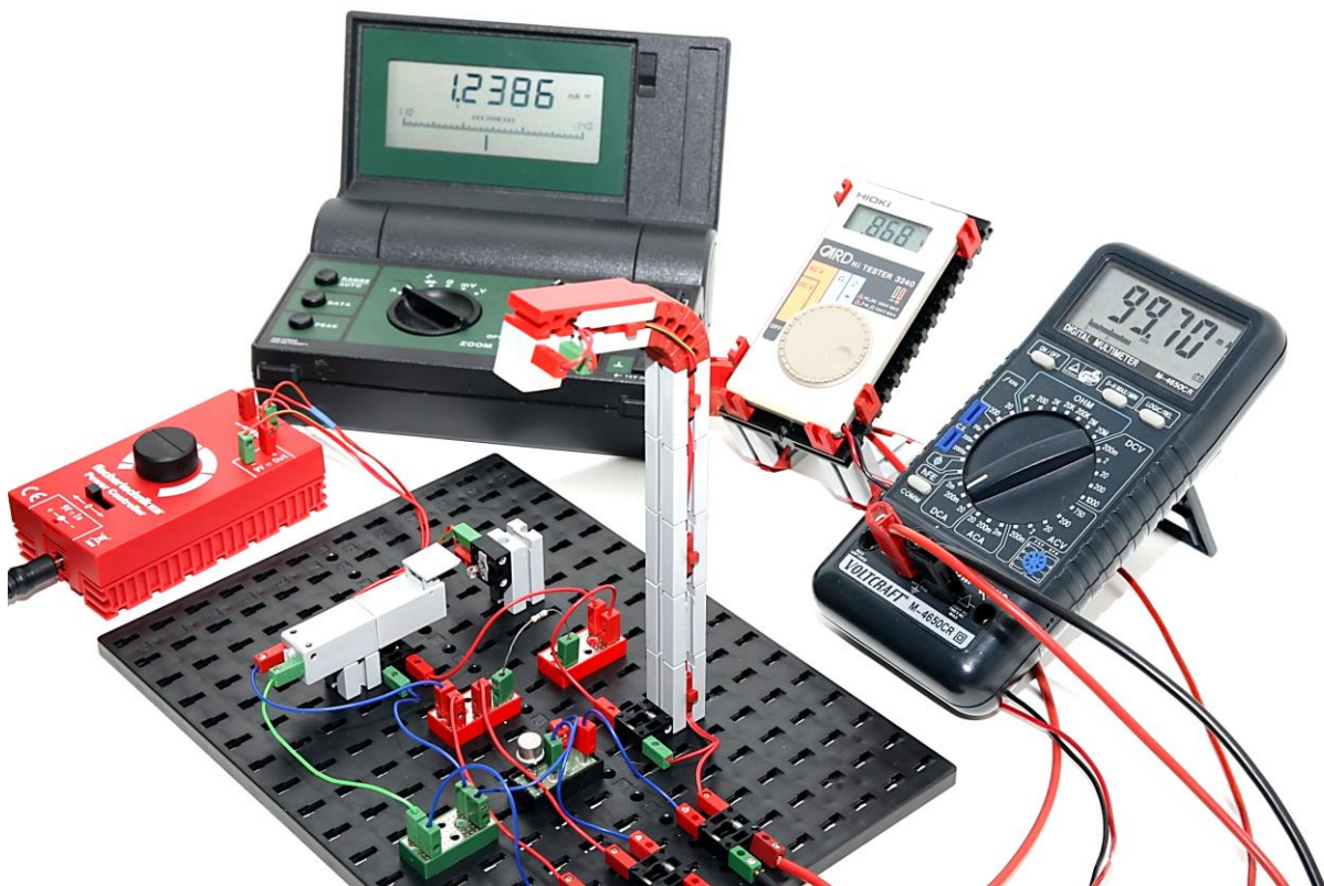
Abb. 22: Dämmerungsschalter mit elektrischer Dämmerung
