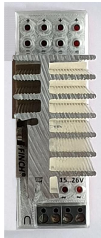
Abb. 12: Draufsicht auf das Versorgungsmodul V2
