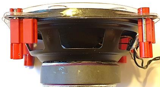
Abb. 10: Befestigung des Lautsprechers mit vier Achsen 30, Baustein 7,5 und Klemmbuchsen
