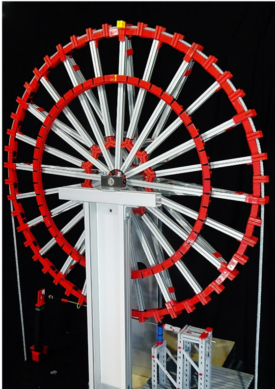
Abb. 5: Die fertige Seilscheibe auf dem Montagegestell
