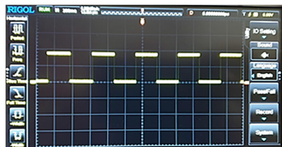
Abb. 2: Ausgangssignal als Rechteck-Takt
