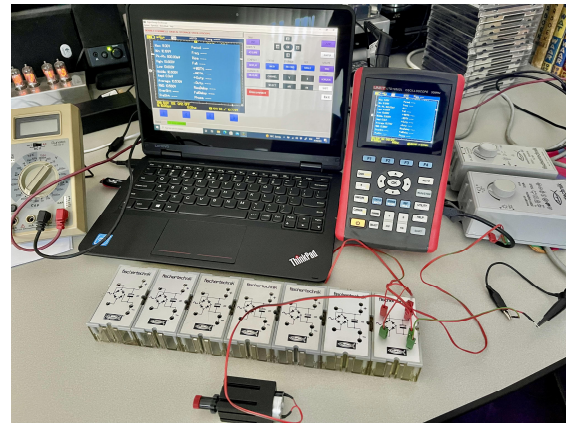
Abb. 11: Mehrere h4 GB-Gleichrichtermodule auf dem Prüfstand
