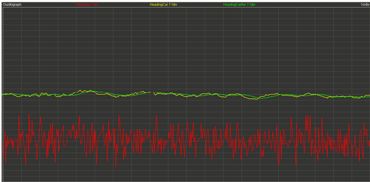
Abb. 20: Heading \psi des mit der x-Achse des Beschleunigungssensors nach Norden ausgerichteten Kombisensors ohne (rot) und mit (gelb) Kalibrierung sowie als gleitender Durchschnitt über 20 Messwerte mit Kalibrierung (grün) [Skala: 1s/1°] (Programm: Kalibrierte Kompass-Messung mit Mittelwertbildung.rpp)
