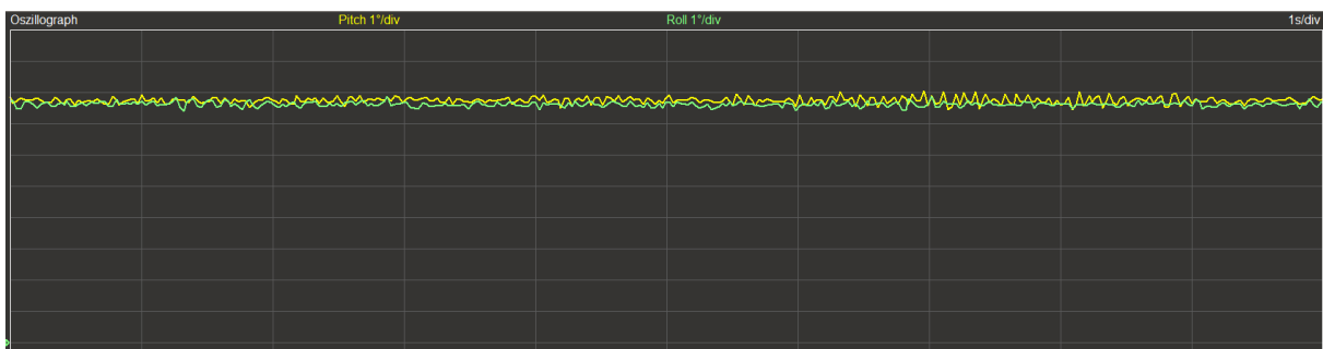
Abb. 13: Pitch und Roll, wenn der Sensor auf zwei um 90° versetzten Winkelsteinen 7,5° montiert wird [Skala: 1s/1°] (Programm: Berechnung von Pitch und Roll.rpp, siehe Abb. 14)
