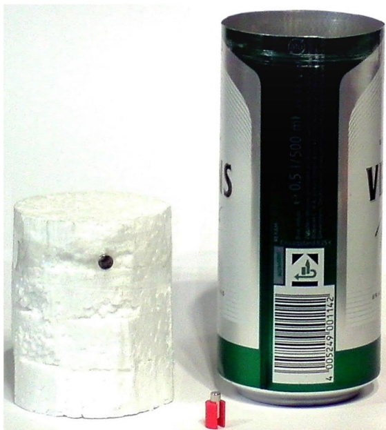
Abb. 2: Aufgeschnittene Dose und Verdränger
