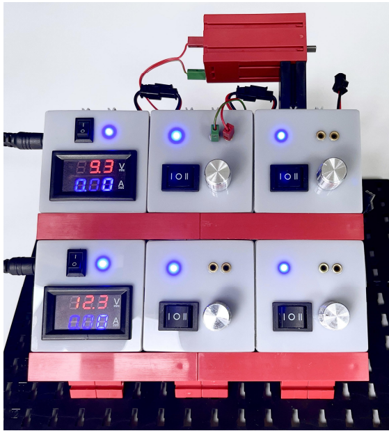
Abb. 2: Leistungsmodule und Drehzahlregler in fischertechnik-Kassetten
