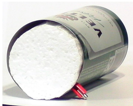
Abb. 3: Der Verdränger hat einen kleineren Durchmesser als die Dose
